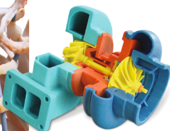
Turbodmychadlo - koncepční model s různě obarvenými komponenty pro odlišení.
